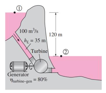
Calcolare la potenza elettrica fornita dalla turbina sapendo che le perdite di carico per attrito valgono 35m.
