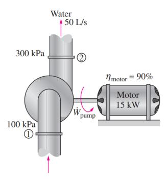
Calcolare la potenza elettrica assorbita dalla pompa con diametro in ingresso uguale a quello in uscita e un dislivello di 1m.
